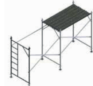
Montando o elemento horizontal
